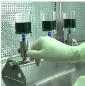
Retirar la tapa del embudo y verter la muestra en el mismo y filtrar aplicando vacío.
