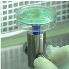
Colocar la tapa y aplicar un breve vacío nuevamente para que el medio traspase la membrana y se absorba en el pad de celulosa.
